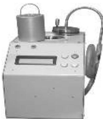
Рис. 10.6. Десорбер для очистки концентраторов
