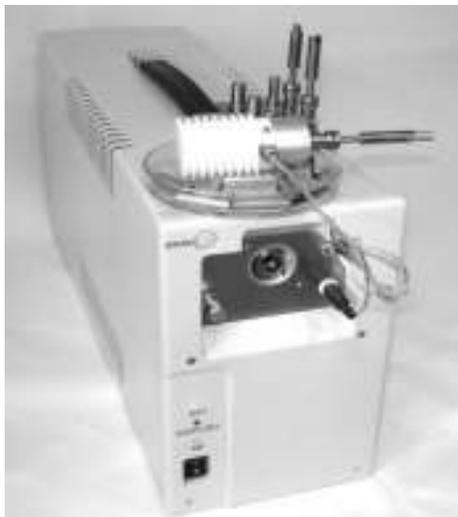
Рис. 10.8. Портативный хроматограф ЭХО-В-ФИД с фотоионизационным детектором, поликапиллярной колонкой и устройством ввода проб с пассивного концентратора (на крышке прибора)
