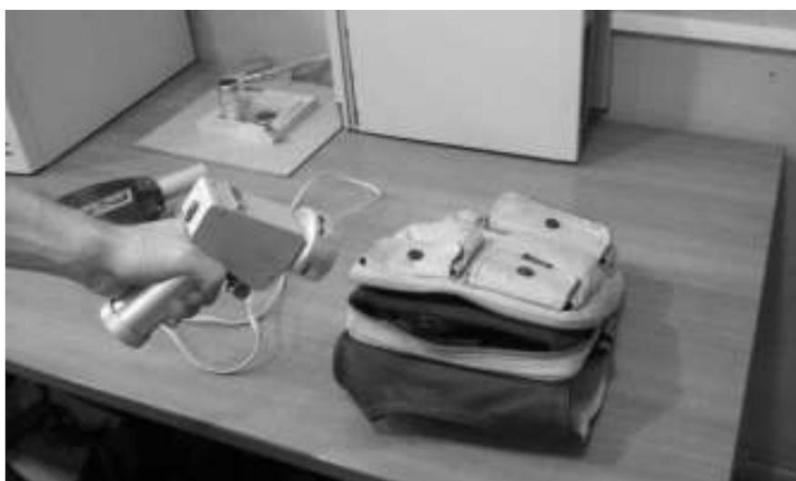
*Рис. 8.4.* Применение вихревого пробоотборного устройства для обследования объекта
